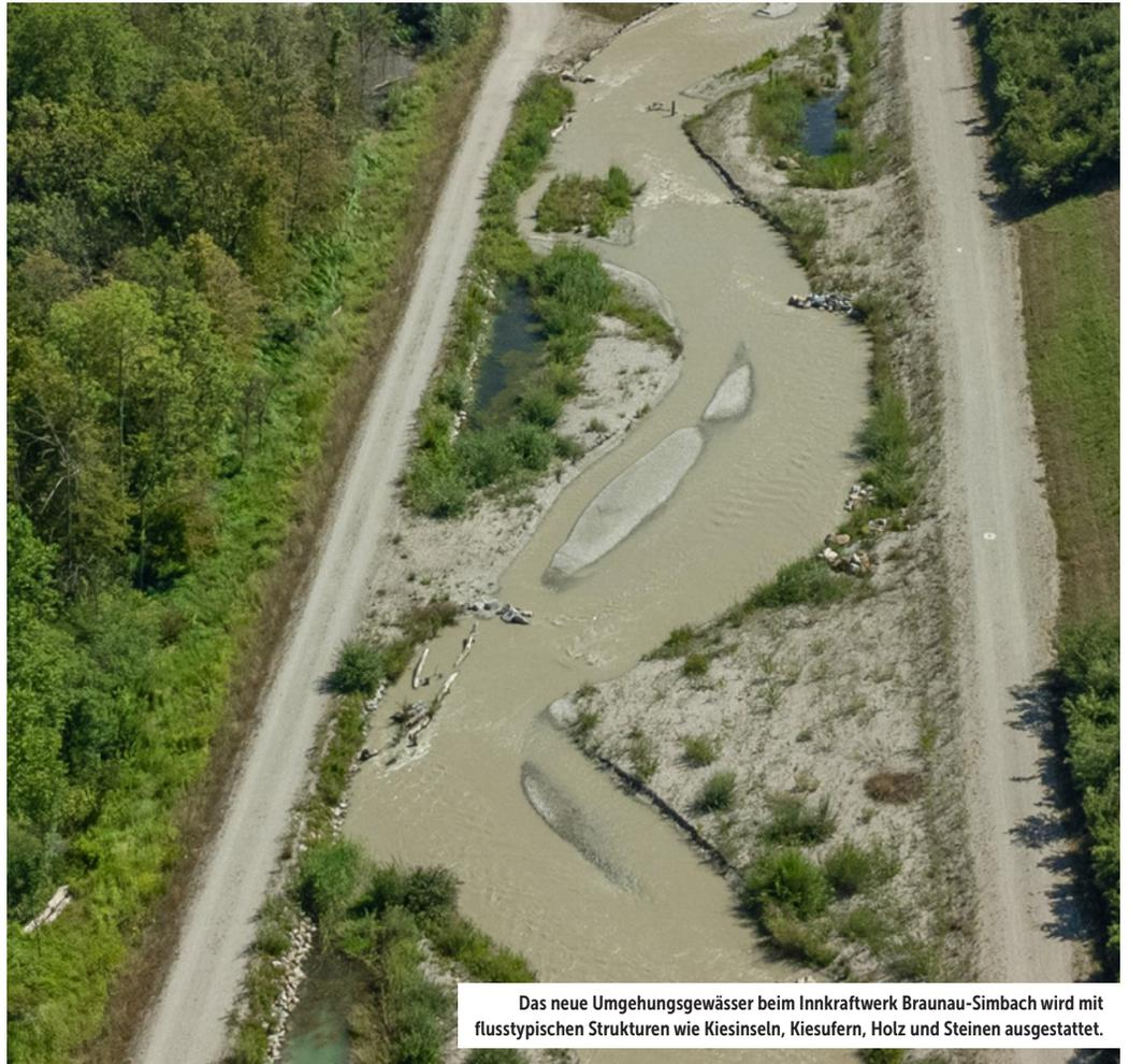
Das neue Umgehungsgewässer beim Innkraftwerk Braunau-Simbach wird mit flusstypischen Strukturen wie Kiesinseln, Kiesufeln, Holz und Steinen ausgestattet.
